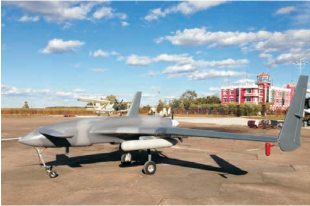
图 2 CH-3 无人机航空磁测系统
