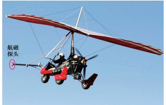
图 9 动力滑翔机航磁勘查系统
