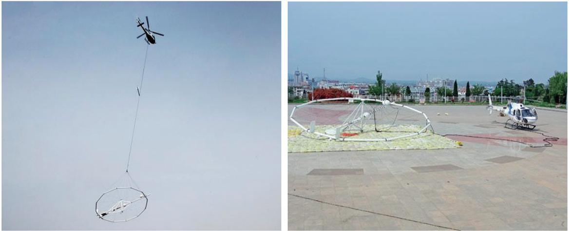
图 5 直升机吊舱式时间域航空电磁勘查系统
