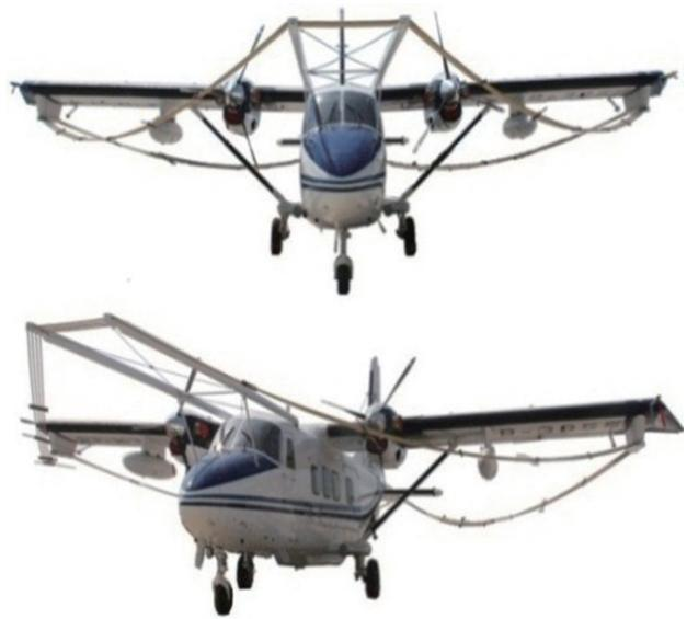
图 2 时间域固定翼航空电磁勘查系统
