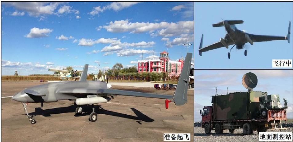
图 7 国内首套 CH-3 型无人机航空(磁、放)综合勘查系统
