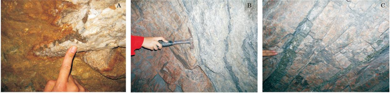
A—乳白色石英含硫化物矿石,金含量  $13.6 \times 10^{-6}$ ; B—含大量黄铁矿的强硅化绢英岩化矿石,金含量  $40.5 \times 10^{-6}$ ; C—强钾化花岗岩中多条含硫化物线及细脉组成的矿体,金含量  $66.8 \times 10^{-6}$
