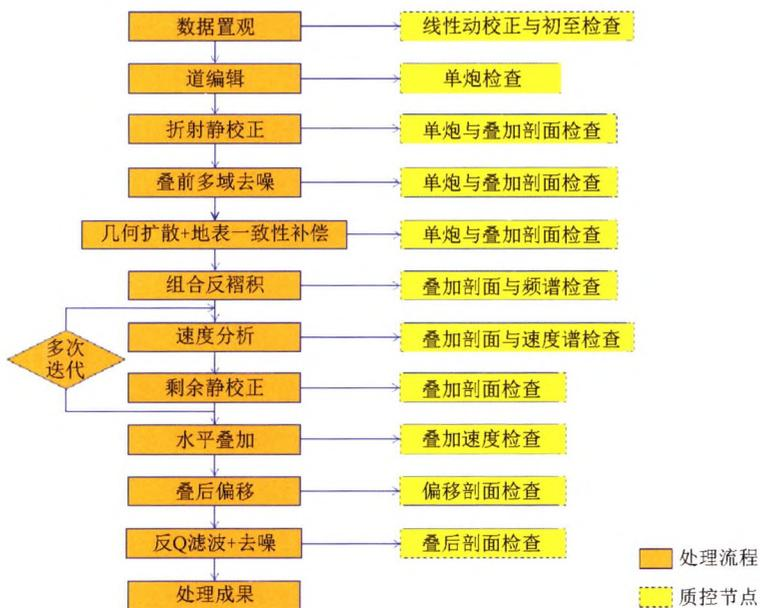
图6 工区浅层地震数据处理流程
