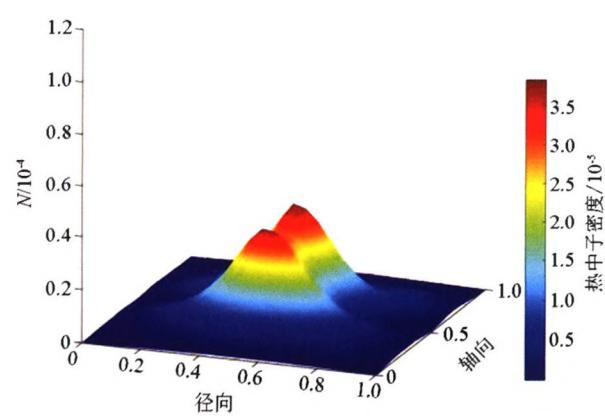
图 5  $90^\circ$  裂缝介质中水层中的热中子密度分布
