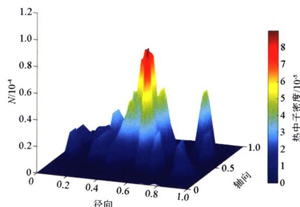
图 3  $50^\circ$  裂缝水层中的热中子密度分布
