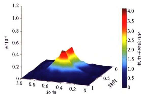
图1 低角度裂缝水层中的热中子密度分布
