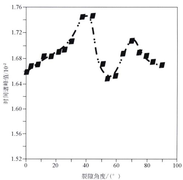
图 7 水层中不同角度裂缝介质中的时间谱最大值
