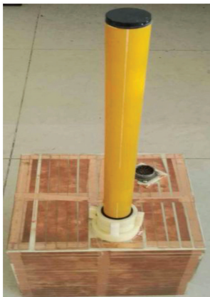
图 5 安装了定向器的三分量磁场传感器
