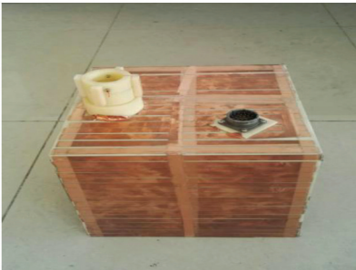
图 3 三分量感应式磁场传感器外形图
