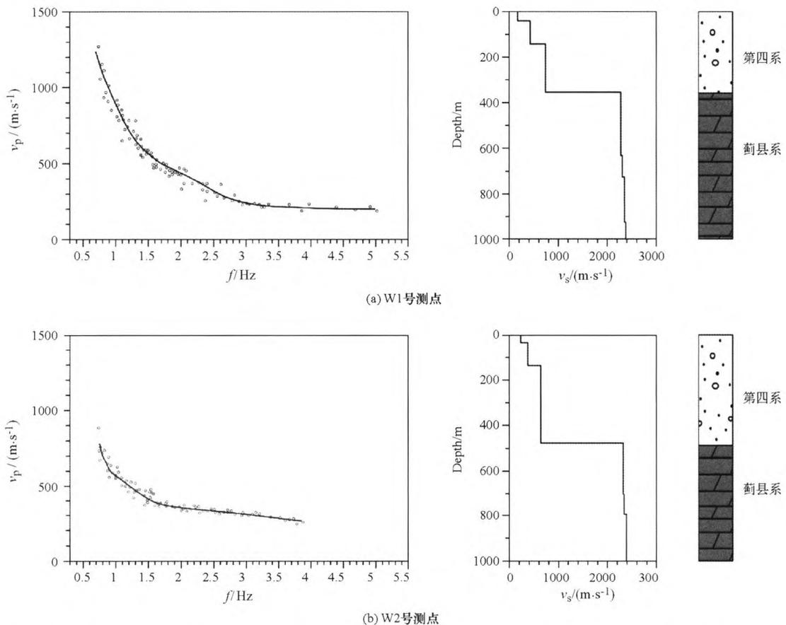
a—W1 号测点频散曲线(左)、视 S 波速度结构(中)、地质解释(右); b—W2 号测点频散曲线(左)、视 S 波速度结构(中)、地质解释(右)
