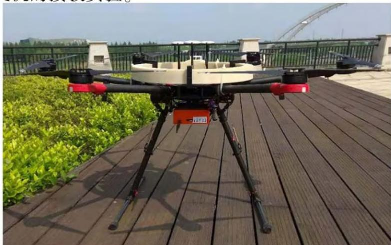
图 6 接收器、线圈与飞机的接驳
