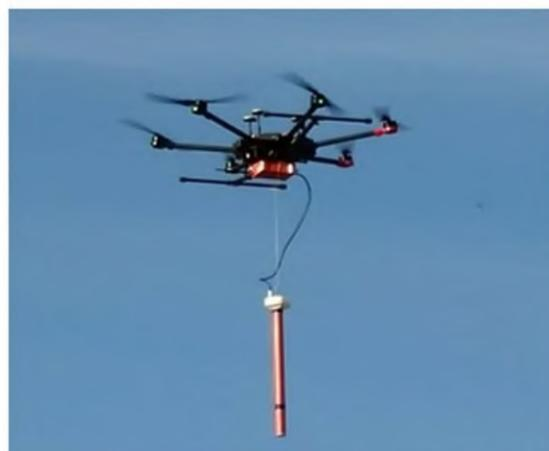
图 7 接收器、磁棒与飞机的接驳(软连接)
