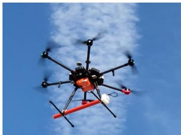
图 8 接收器、磁棒与飞机的接驳(硬连接)
