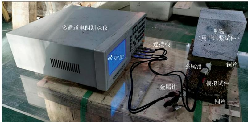
图 3 电阻测试系统示意
