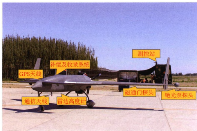
图 1 CH-3 型无人机航磁测量系统
