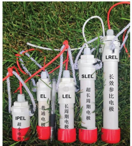
图 1 自主研制免维护固体非极化电极实物图
