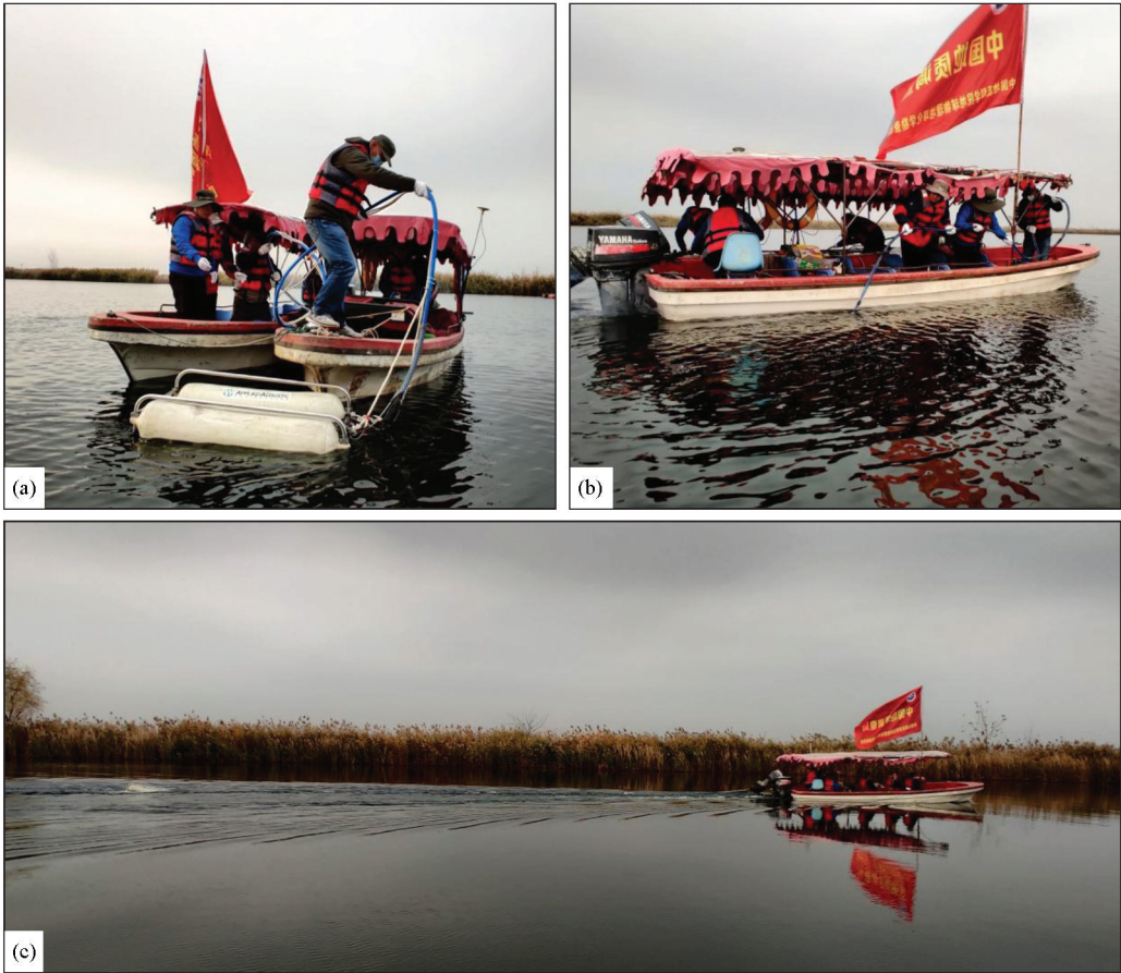
a—投放 Boomer 激发震源;b—投放水听器电缆;c—拖曳式单道地震数据采集 a—release the Boomer source;b—drop the hydrophone cable;c—towed single-channel seismic acquisition 图 2 内陆浅水区单道地震探测现场工作
