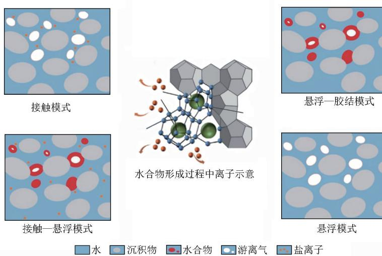
图 4 水合物的形成过程及孔隙中的赋存状态<sup>[7]</sup>Fig. 4 Hydrate formation process and occurrence state in pores<sup>[7]</sup>
