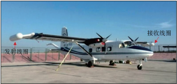
图 3 测量系统及搭载飞机示意
