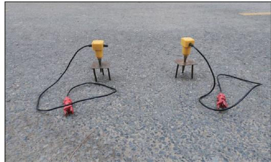
图 3 安装了检波器的三角支架
