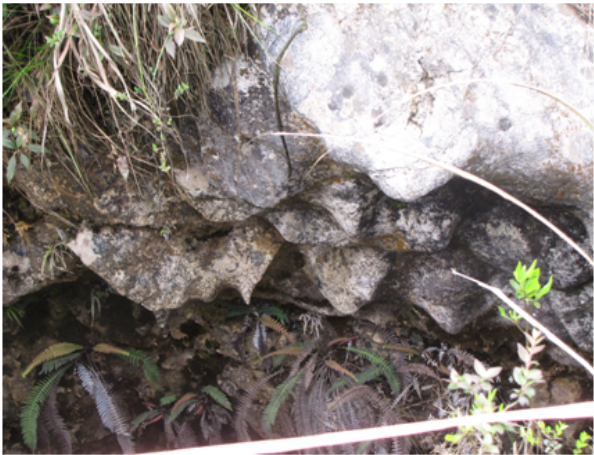
图 1 危岩体错坎面溶蚀
