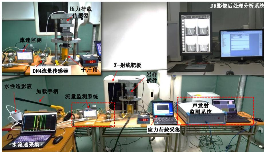
b. 碳酸盐岩破裂过程中管道—裂隙水流动可视化试验平台
