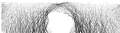
图19 具有拱状结构的颗粒接触力分布
