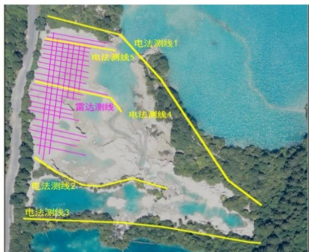
图4 火花海无损探测测线布置示意图
