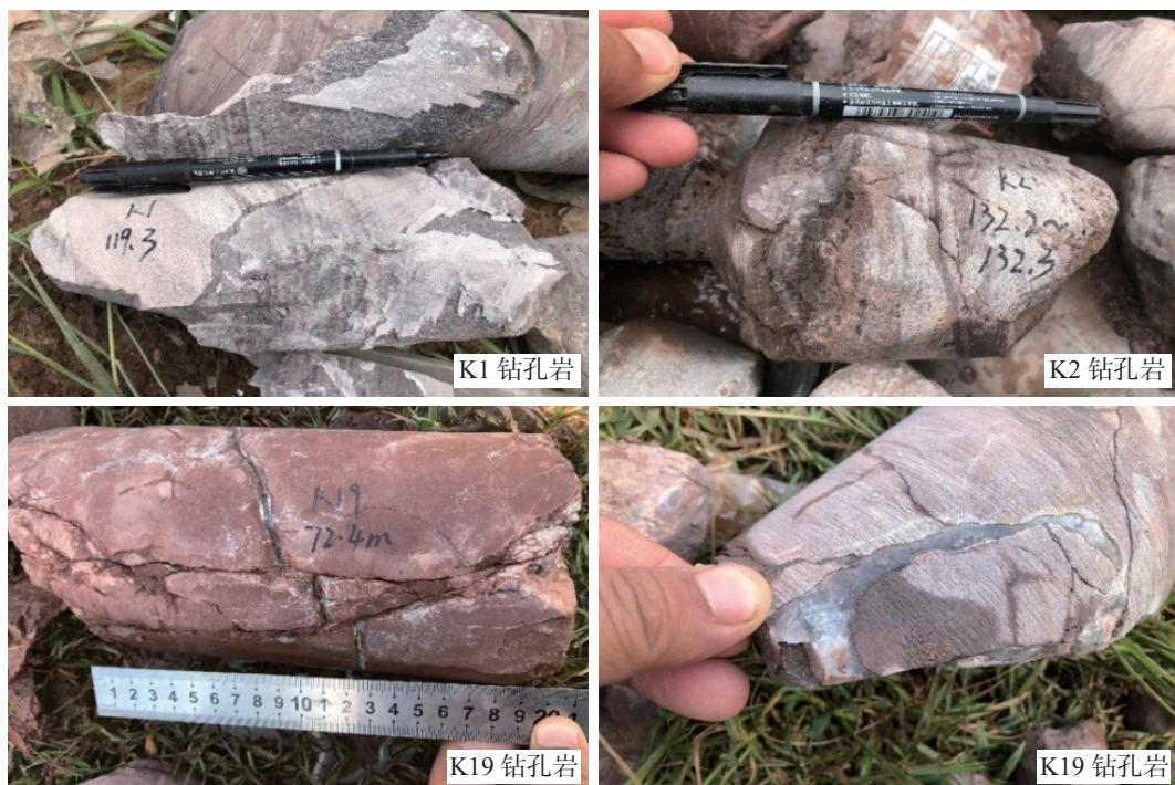
图4 钻孔K1、K2和K19岩芯中的裂隙状石膏
