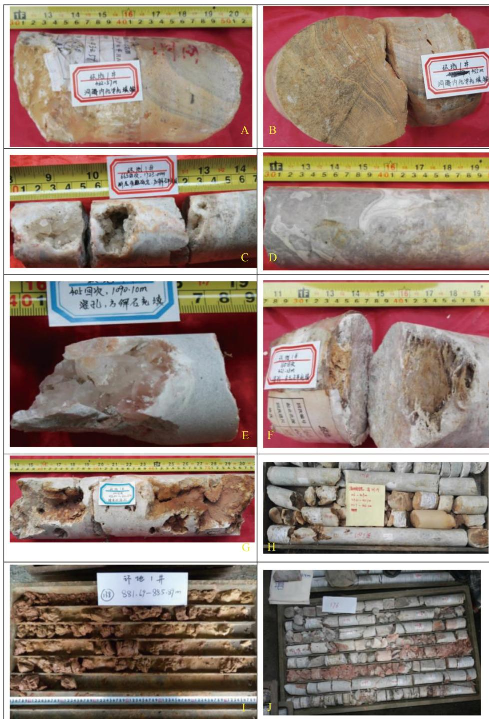
图 3 岩芯中不同类型充填物生长或充填形态
