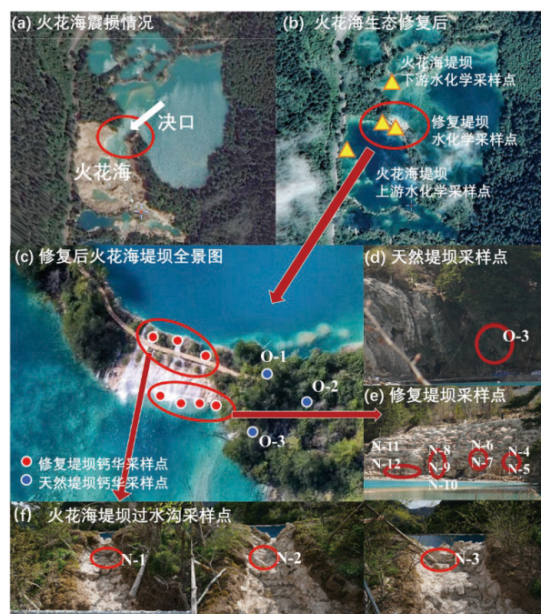
图 1 (a)地震破坏的火花海;(b)决口堤坝修复后的火花海;(c)修复堤坝全景图以及钙华和水样的采集点;(d-f)火花海堤坝上钙华样品采集点
