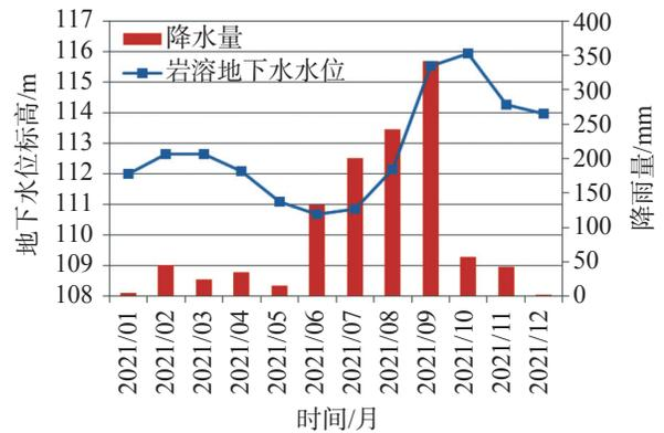
图 4 2021 年旧县岩溶水 225 监测孔年内地下水动态-降雨量曲线
