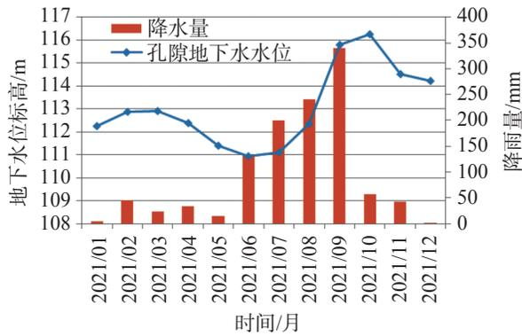
图 2 2021 年旧县孔隙水 296 监测孔年内地下水动态-降雨量曲线
