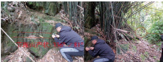
图 9 地质点(D2)控制岩溶通道节理构造特征
