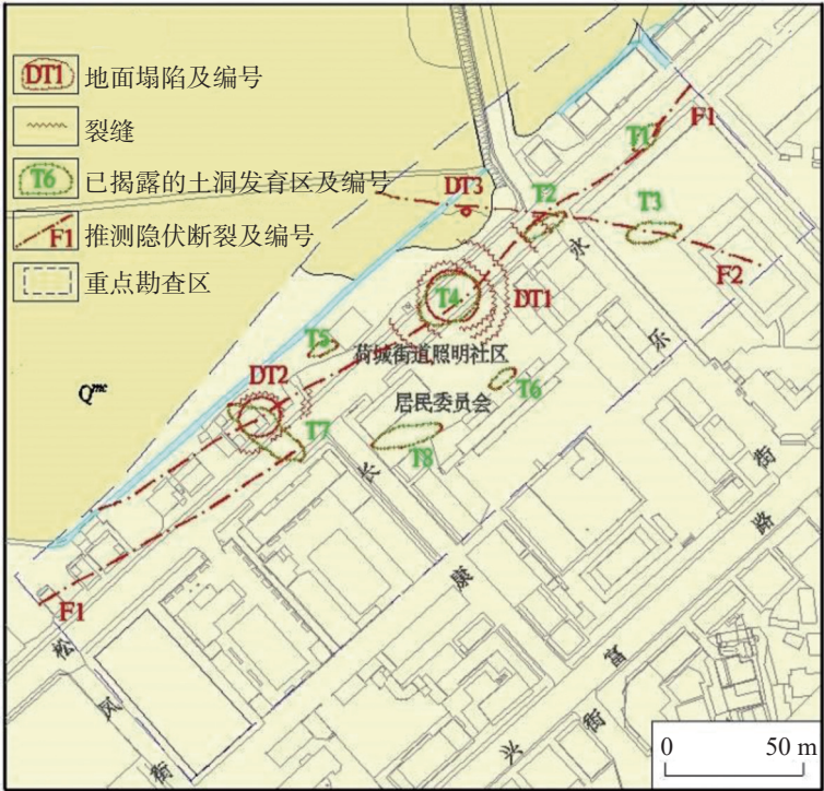
图 5 土洞发育分布图 Fig. 5 Development distribution of soil caves
