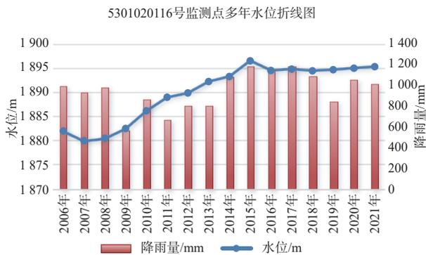
图 8 孔隙水典型监测点多年水位折线图
