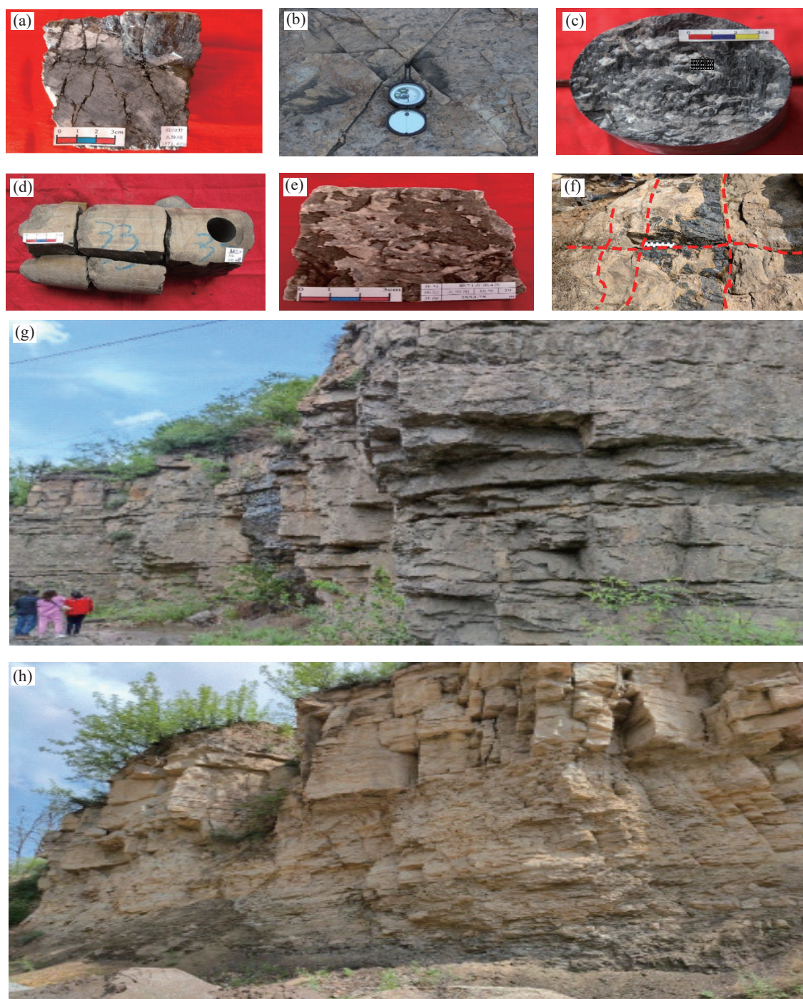
图4 太原组灰岩构造缝发育特征
