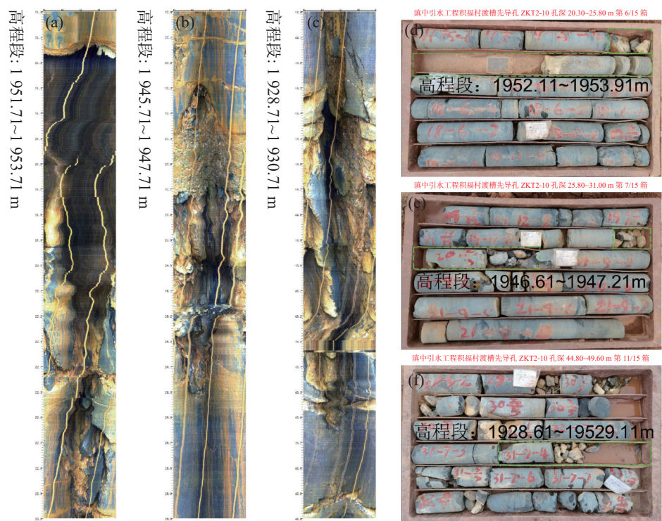
图 9 ZKT2-10 钻孔全景数字成像及钻探取心成果
