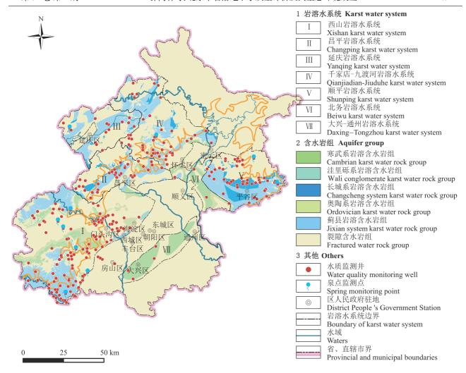
图 1 北京岩溶水系统划分及采样点分布图
