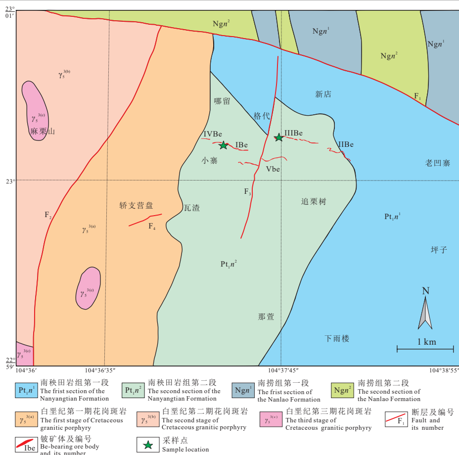
图2 瓦渣钨铍矿区地质简图 ① Fig.2 Geological map of Wazha W-Be deposit ①
