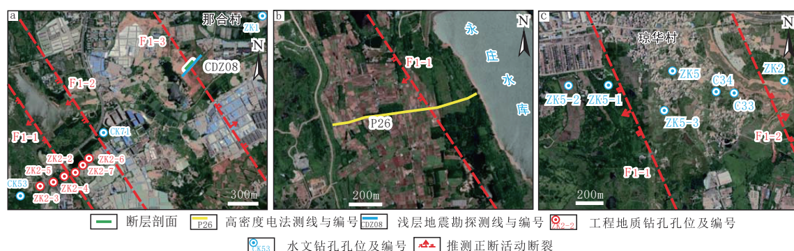
a—海口砖瓦厂断层剖面、浅层人工地震测线以及钻孔分布图；b—永庄水库高密度电阻率法测线分布图；c—琼华村钻孔分布图
