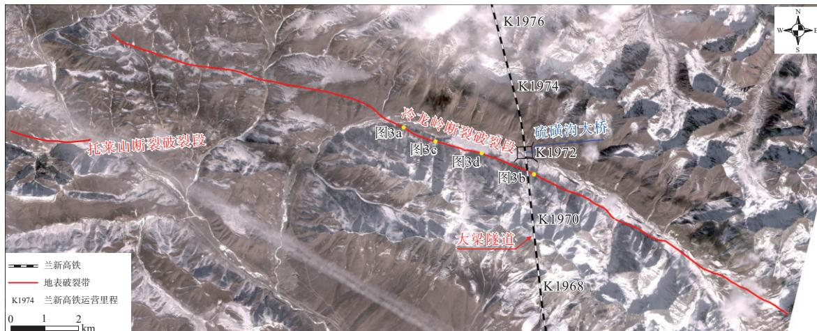
图 2 青海门源  $M_s$  6.9 地震同震地表破裂带分布图
