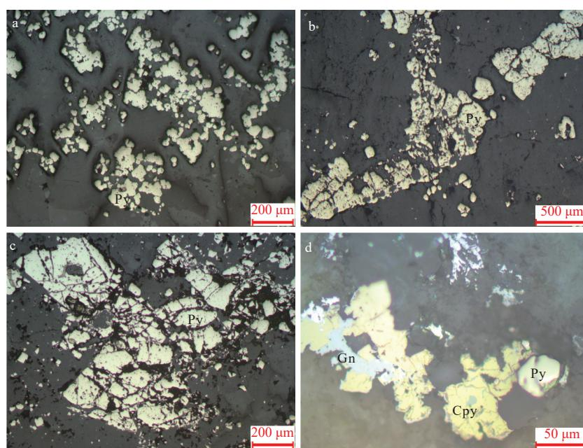
Py—黄铁矿；Gn—方铅矿；Cpy—黄铜矿
