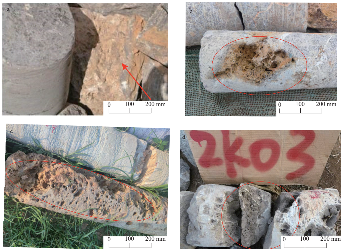
a—溶蚀裂隙; b—溶孔; c—蜂窝状溶孔; d—溶洞
