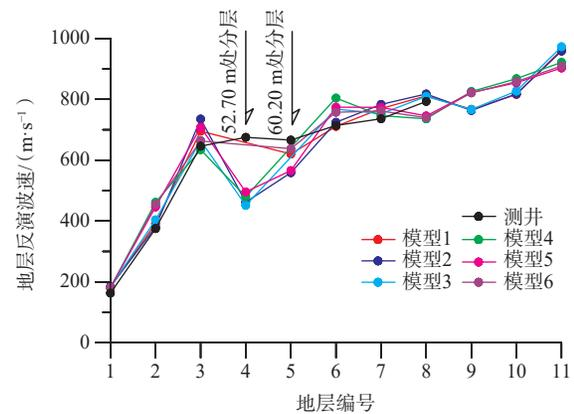
图 9 模型 1—6 地层反演波速对比
