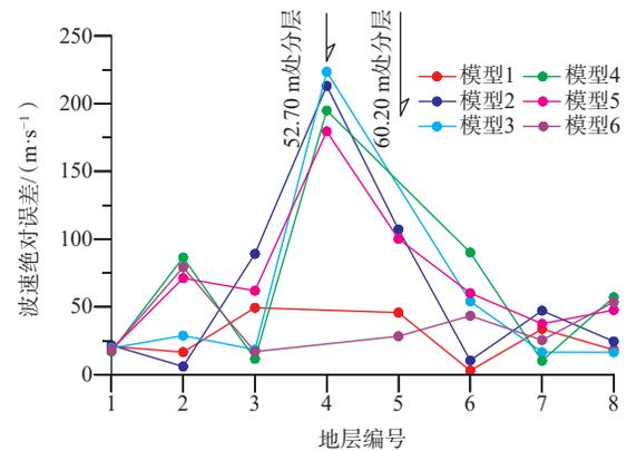
图 10 模型 1—6 地层反演波速绝对误差对比
