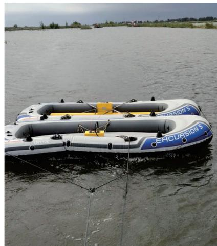
图1 双皮划艇搭载水上雷达数据采集现场
