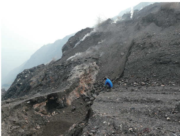
图 3 滑坡中部的开裂陷落带
