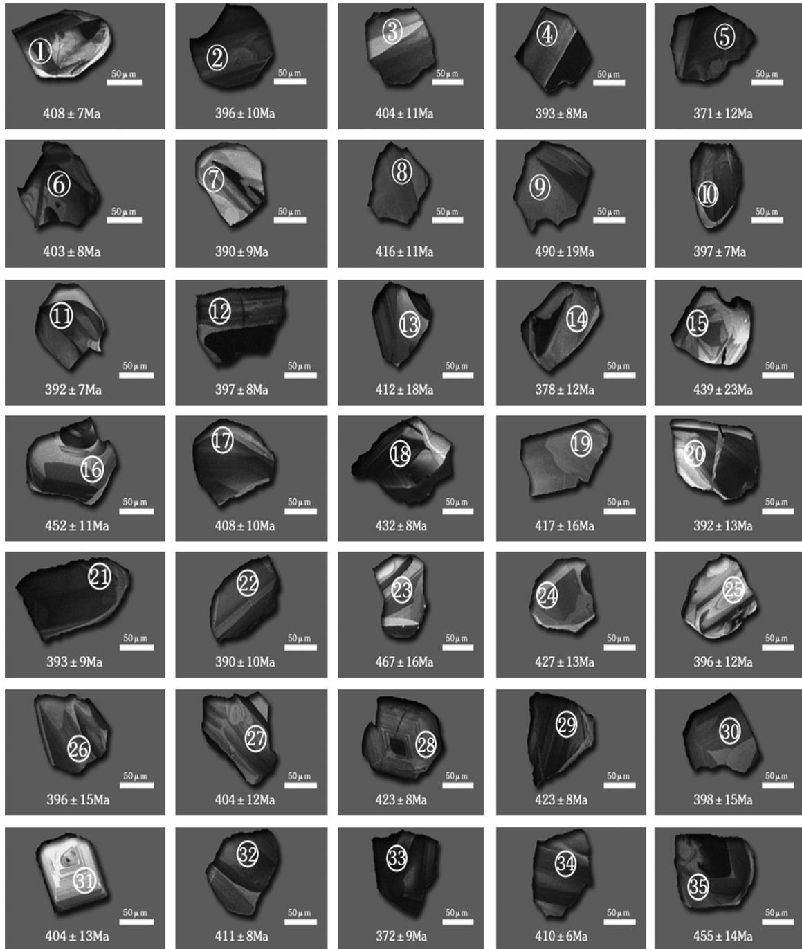
图7 玄武岩(YMQ-TW1)锆石阴极发光(CL)图像
