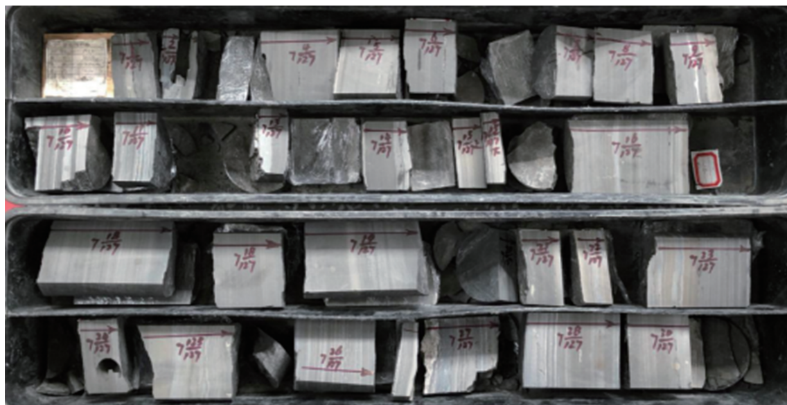
图 4 三塘湖盆地芦 1 井芦草沟组岩心照片 (3072.39~3076.10 m, 岩心盒长 1 m)
