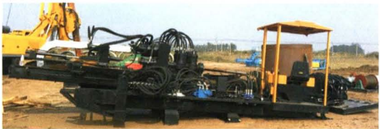
图 6 双回转动力头水平定向钻机
