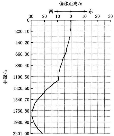
图4 湘永地1井井斜位移东西方向投影图
