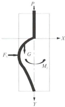
图 6 钟摆力原理纠斜钻进
