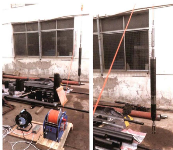
图 5 泥皮清理装置室内实验
