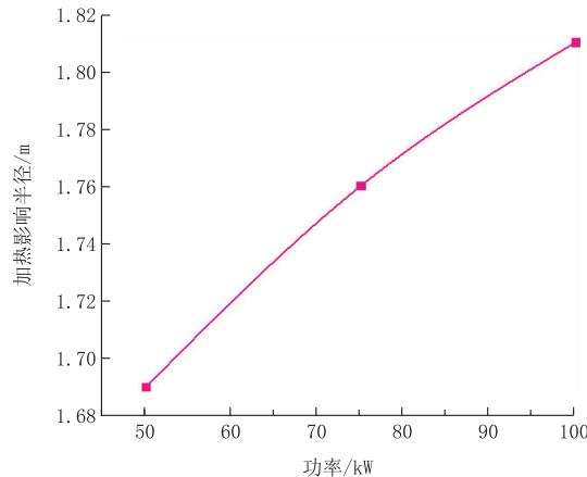
图 7 加热影响半径随加热功率的变化
