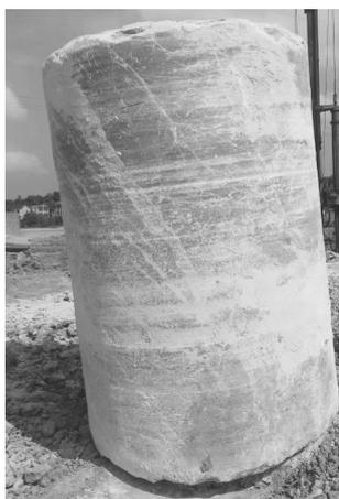
图4 用牙轮筒钻取出的岩心
