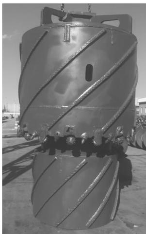
图5 带有前导筒的牙轮筒钻
