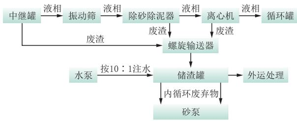
图6 改造后的泥浆不落地处理流程
