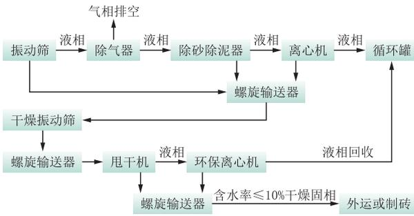
图 3 泥浆不落地系统一般处理流程
