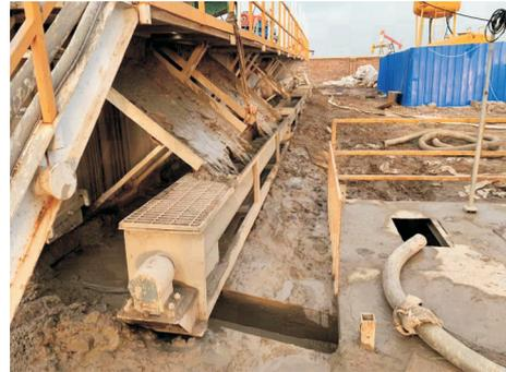
图 4 螺旋输送机
