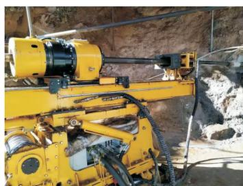
完成该项目的XDQ-1200轻便型岩心钻机,是陕西探地地质装备有限公司在对比国内外同类设备的优缺点的基础上,针对绳索取心钻进工艺的特点,自主研发生产的一种专门针对山区、丘陵地带,适用于中深孔取心钻探,可拆解,适合人工搬运的岩心钻机。该机主要适用于以金刚石复合片、硬质合金为主的岩心钻探。可用于地质勘察、超前地质预报、水文水井、浅层油气等施工领域。
