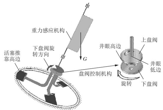
图1 机械式垂直钻具重力感应纠斜机构<sup>[5]</sup>
