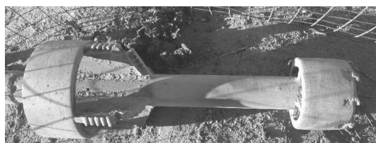
图2 改进后的扩孔钻头
