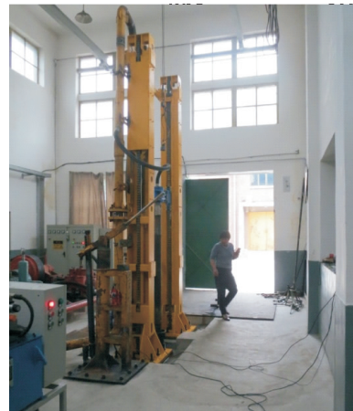
图 6 液动潜孔锤性能测试实验台调试
