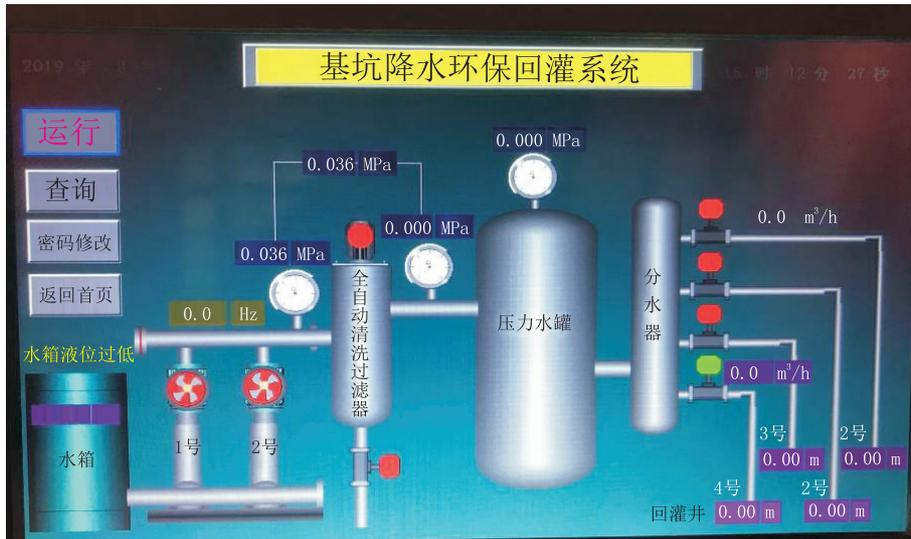
图 12 智能电控系统操作界面
