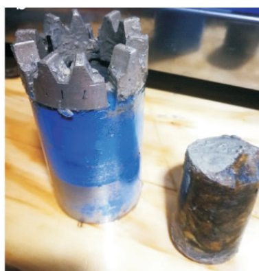
图 12 钻取的冰下基岩岩心及基岩钻头 [62]
